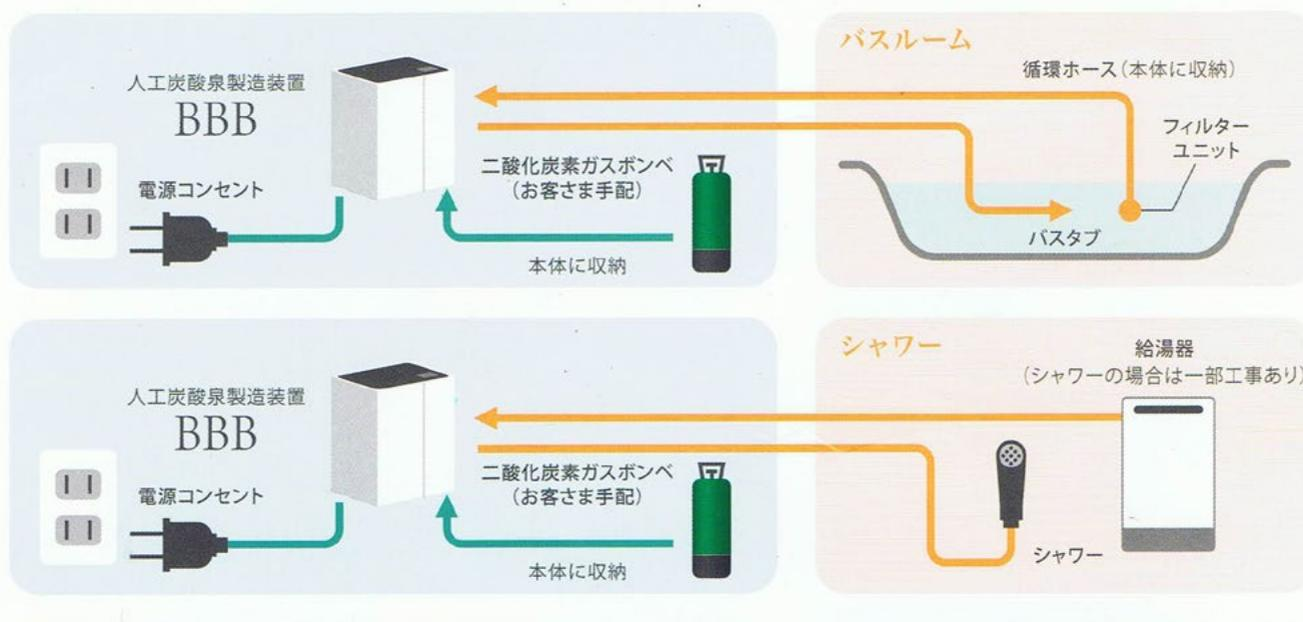
必要な付属品、ガスボンベはすべて本体に収納できるようになっています。(ホース・フィルターユニットは、専用ポリ容器に入れて収納します。) 二酸化炭素ガス(CO<sub>2</sub>ガス)ボンベは、ガス担当会社とお客様との直接契約となります。ご要請いただければ、紹介させていただきます。
